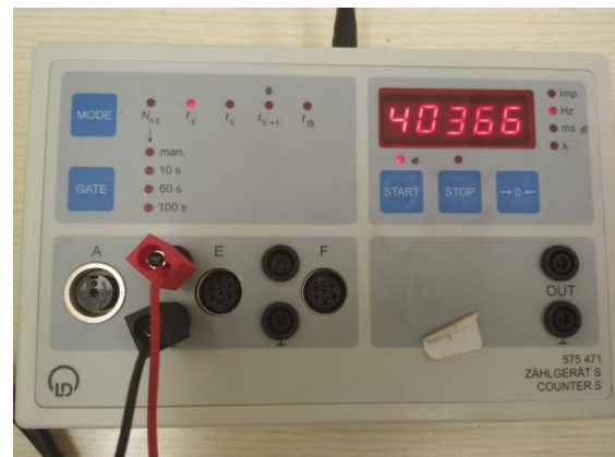
Σχήμα 4β. Ψηφιακός μετρητής (7) για μέτρηση συχνότητας.
