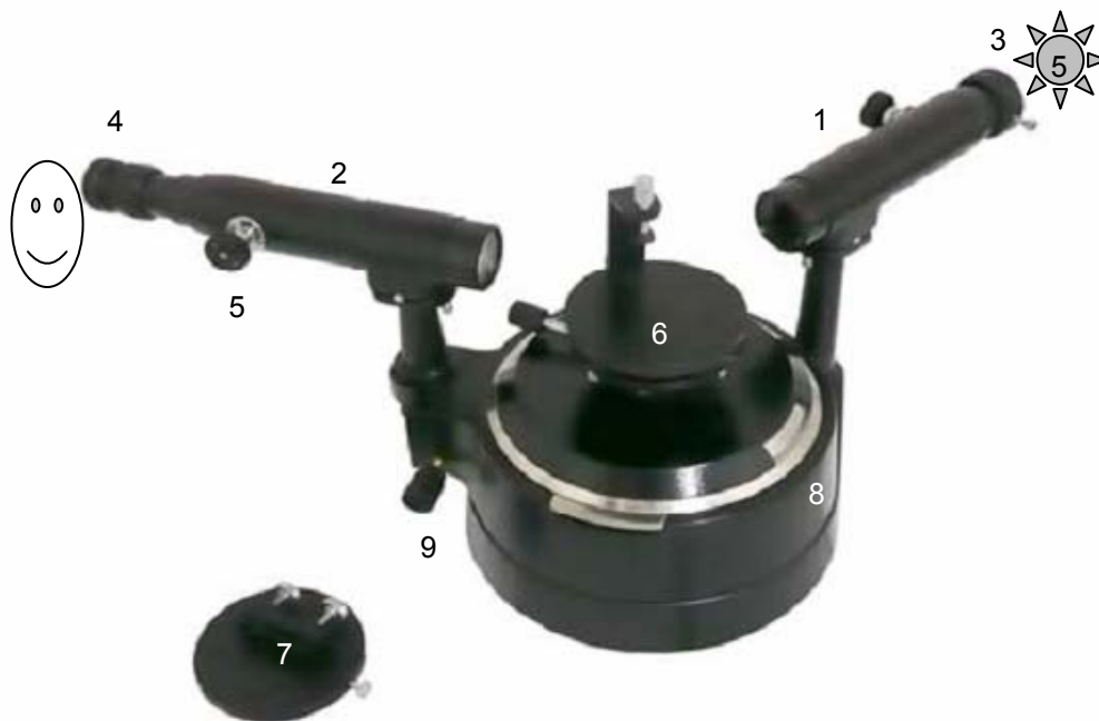
Σχήμα 1. Φασματοσκόπιο: 1. Κατευθυντήρας, 2. Διόπτρα, 3. Σχισμή (ρυθμιζόμενη), 4. Προσοφθάλμιος (με σταυρόνημα), 5. Ρύθμιση ευκρινούς παρατήρησης, 6. Τράπεζα, 7. Βάση πρίσματος, 8. Γωνιόμετρο με βερνιέρο (ένας σε κάθε πλευρά), 9. Σύστημα μικρομετρικής ρύθμισης γωνιακής θέσης διόπτρας
