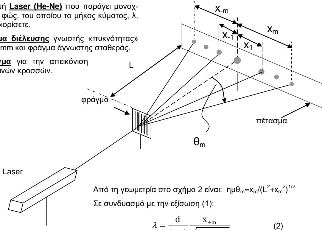
Σχήμα 2: Πειραματική διάταξη
